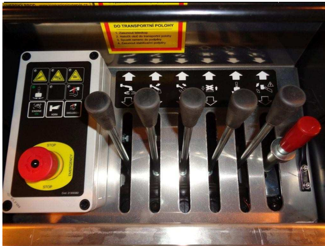
Ovládání přímou hydraulikou páčkovým ovladačem
